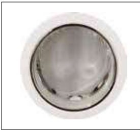
L 150104 luminária de embutir circular em alumínio, foco recuado e difusor em vidro fosco lâmpadas: dulux D/E (opção em LED SMD) | vapor metálico 70W / 150W D: 230mm | P: 120mm | N: 210mm
