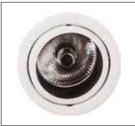
L 150082 luminária de embutir circular em alumínio, foco recuado orientável lâmpadas: AR111 | LED AR111 | CDM-R 111 D: 170mm | P: 70mm | N: 145mm
