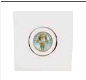
L 160252 luminária de embutir quadrada em alumínio, foco orientável lâmpadas: MR11 | LED MR11 Q: 90mm | P: 40mm | N: 65mm
