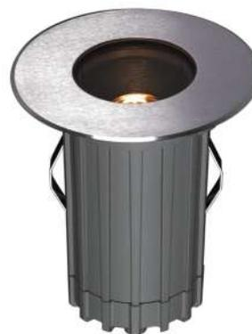
mini balizador embutido com 1 LED, corpo em alumínio injetado e tampa frontal em aço inoxidável, difusor em vidro temperado 6mm e lente de acrílico
