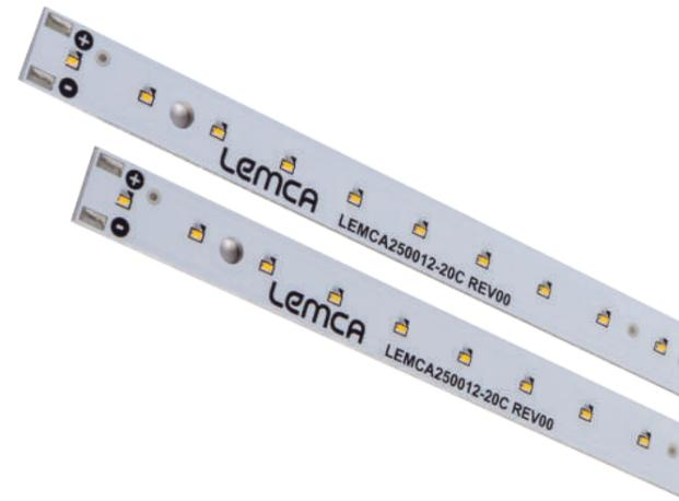
Placa de LED metalcore com LEDs NICHIA e alimentação em corrente constante
