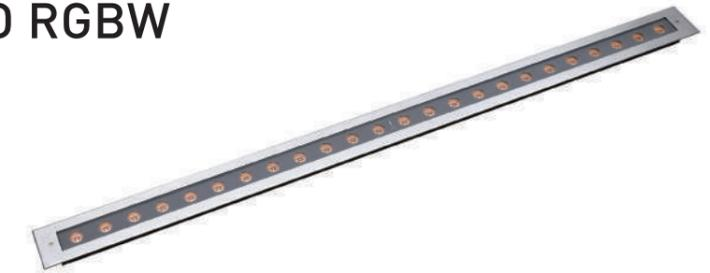
projektor linear embutido para piso com 12 ou 24 LEDs RGBW, corpo em alumínio extrudado com pintura eletrostática, tampa frontal em aço inoxidável cromado, difusor em vidro temperado 6mm e lentes em acrílico
