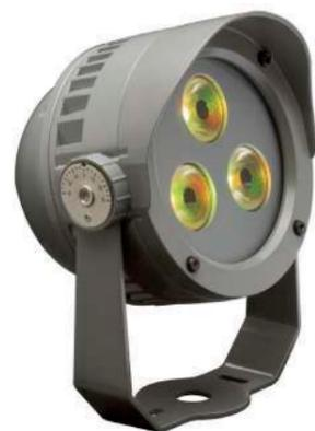
projektor redondo para área externa com 3 LEDs RGBW, feito em alumínio injetado com pintura eletrostática, difusor em vidro temperado 4mm e lentes de acrílico
