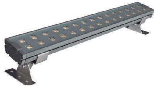
projektor para área externa com alto fluxo luminoso, feito em alumínio extrudado com pintura eletrostática, difusor em vidro temperado 4mm e lentes de acrílico
