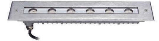
projektor linear embutido para piso, indicado para área externa com 6 LEDs, fecho simétrico ou assimétrico, corpo em alumínio injetado com pintura eletrostática, tampa frontal em aço inoxidável cromado difusor em vidro temperado 8mm e lentes em acrílico
