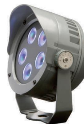
projektor redondo para área externa com 5 LEDs RGBW, feito em alumínio injetado com pintura eletrostática, difusor em vidro temperado 4mm e lentes de acrílico
