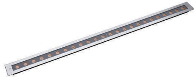
projektor linear embutido de solo com 12 ou 24 LEDs, corpo em alumínio extrudado, tampa frontal em aço inox, difusor em vidro temperado 6mm e lentes em acrílico
