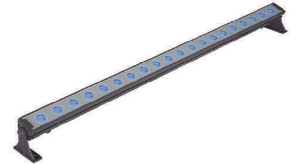
projektor linear para área externa RGBW, feito em alumínio extrudado com pintura eletrostática, difusor em vidro temperado 3mm e lentes de acrílico
