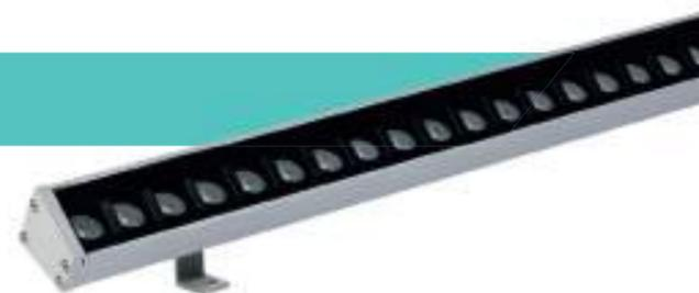
Projeto linear para área externa feito em alumínio extrudado com pintura eletrostática, difusor em vidro temperado 3mm e lentes de acrílico.
